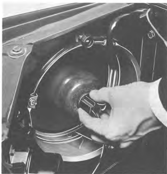
Demontering av kopplingskontakt
