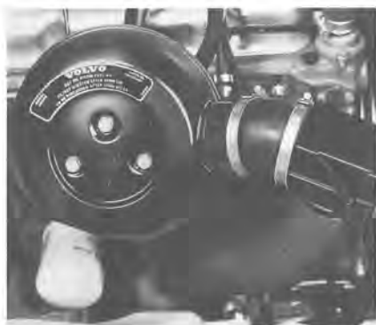
Luftrenare (Motor B20A)
