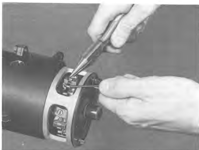
Bild 2 Demontering av kol
