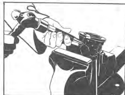
Utdrivning av lagerhållare
