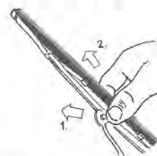
Fig 2 Byte av torkarblad, demontering
