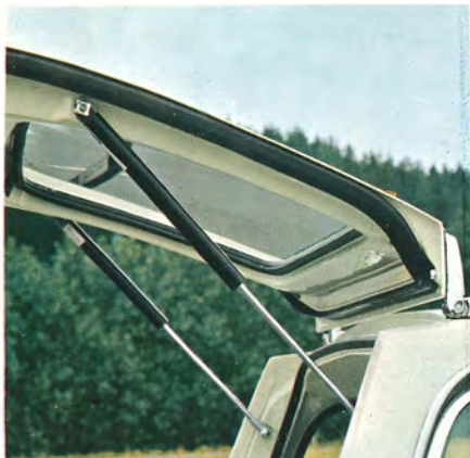
Bakluckan lyfts automatiskt med två kraftiga gasfjädrar.
