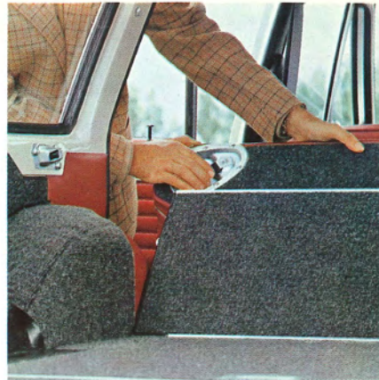
Spärren för baksätets ryggstöd lossas lätt från vänster eller höger sida med endera av de två sammankopplade låshandtagen.
