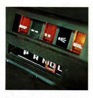
Volvos automatväxellåda är treväxlad men har dessutom en hydraulisk momentomvandlare. Den ger en variabel utväxling mellan de tre växelstegen — och bl a extra stor dragkraft i startögonblicket. S k delgasnedväxling ger smidig nedväxling när ni t ex rundar ett gathörn.
