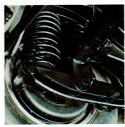
separata element för varje funktion. I längsled hålls axeln på plats av underliggande bärarmar, och i sidled av tvärstag. För fjädringen används spiralfjädrar. Dämpning med dubbelverkande hydrauliska stötdämpare. Momentstavar hindrar axeln att vrida sig. Ett helt nytt hjullagersystem innebär att bakaxelns livslängd ökas liksom förmågan att uppta sidokrafter. Konstruktionen förenklar även servicen på hjullagren. Volvo 164 är den första bilen i världen med detta system.
