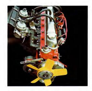
Volvos B30-motor. Sex cylindrar. 3 liters cylindervolym. För acceleration i särklass. För jämn, lugn gång under milslukande långfärder. Lyssna på den. Prova segdragningsförmågan i stadstrafik. Upplev Volvo 164. Ett rationellt val i sin klass. Konstatera själv med en ordentlig provtur och en grundlig kalkyl.
