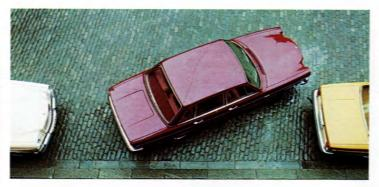
Volvo 164 har en avancerad styrkonstruktion med variabel utväxling. Med hjulen rakt fram är den liten — ni håller bekvämt kursen med små korrigeringar med ratten. Vid stora hjulutslag är utväxlingen stor — ratten går lätt vid t ex fickparkeringar. Ni kan också få Volvo 164 med servostyrning.
