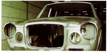
Karossen är uppbyggd så att passagerarutrymmet är ett starkt skyddande skal, där alla öppningar är förstärkta med slutna balkar. Även taket är förstärkt med tvärgående balkar. Samtliga dörrar har säkerhetslås.
