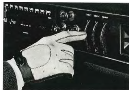
Luftens fördelning och temperaturen regleras med infällda belysta rattar. En termostat håller inställd temperaturnivå.
