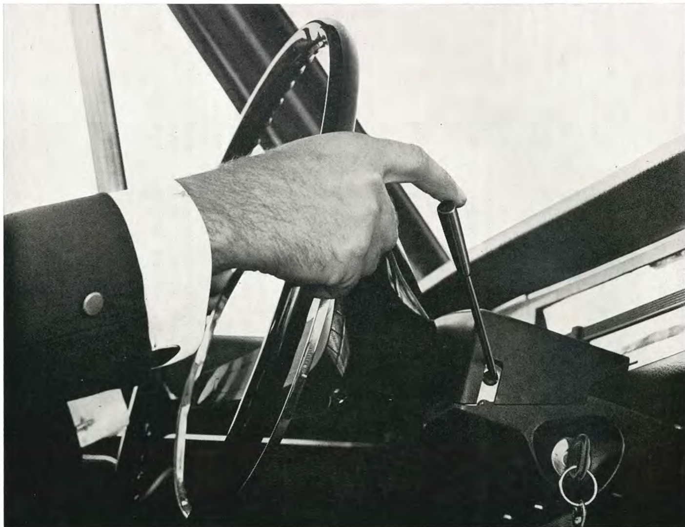
En Volvo med överväxel har 5 växlar — och kopplingsfri växling mellan de två högsta växlar. En Volvo med överväxel har 5 växlar — och kopplingsfri växling mellan de två högsta växlar.
