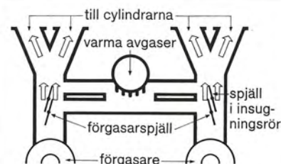
Vid högt motorvarv öppnas spjällen helt och bränsle-luftblandningen går direkt från förgasarna till cylindrarna.
