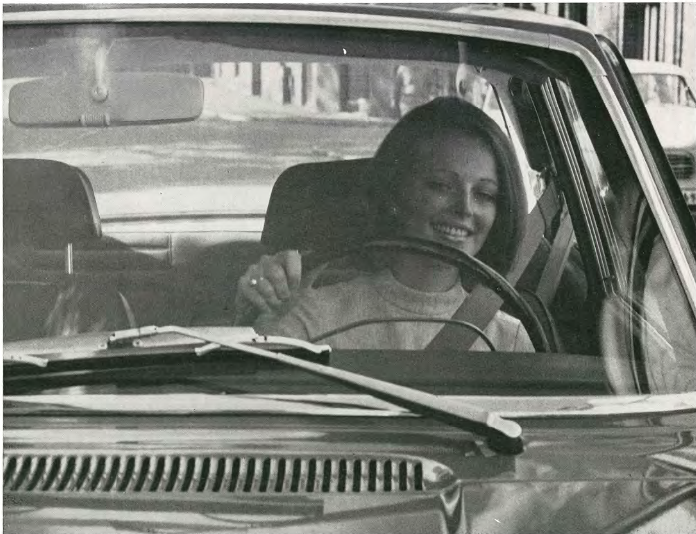
Volvos nya vindruta av "high impact"-typ ger effektivt skydd mot skada utifrån och förebygger "inre" skada. Föraren har fullgod sikt även efter ett kraftigt stenskott.
