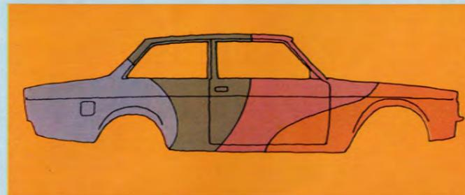
Volvos rostskydd omfattar också: 1) Fosfatering av karossen; 2) Doppning i elektrolytiskt bad; 3) Ugnshärdning; 4) Fyllerlackering och fogtätning; 5) Täcklackering. Dessutom sprutas underredet med rostskyddsvätska och underredsmassa redan i fabriken. Rostskydd i alla balkar och slutna sektioner hjälper också till att hålla rosten borta.
