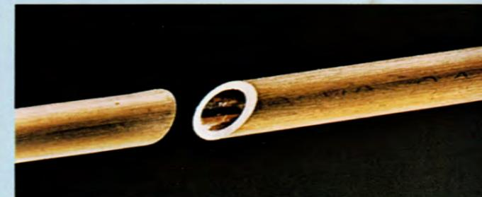
Bromsrören på Volvos 240-vagnar är tillverkade av rostbeständig legering av koppar och nickel. Det är framför allt en fråga om säkerhet.
