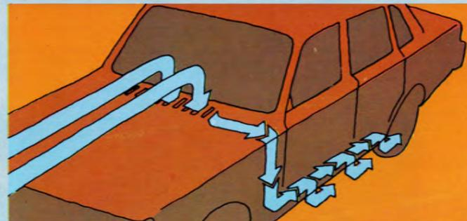
Dörrtrösklarna är konstruerade så att de genomluftas och hålls torra av fartvinden. De sprutas dessutom på utsidan med polyester. Allt för att förebygga rost.
