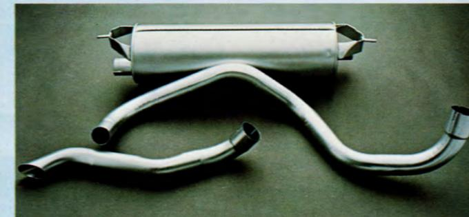
Avgasrör och ljuddämpare är tillverkade av rostskyddsbeständig, aluminiserad plåt på de mest utsatta ställena. Det ger längre livslängd och därmed lägre kostnader på sikt.
