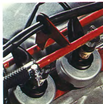
B 20 E — elektronisk insprutningsmotor. 130 hk SAE. Hög effekt och nära nog fullständig förbränning.
