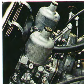
Tvåförgasarmotorn på 105 hk SAE har extra kraft och temperament.
