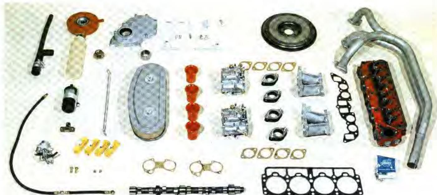
Bilden visar de olika detaljer som ingår i trimningsatsen. Vidare innehåller satsen för monteringen erforderliga muttrar, brickor o. dyl. Komplet sats eller delar av den kan beställas från Volvo
