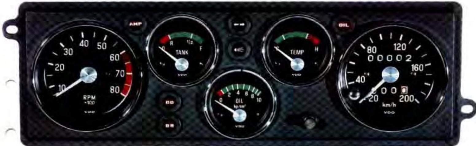
Bilsport i mera avancerade sammanhang kräver en komplettering av instrumentbrädans standardutrustning. VOLVO Competition Service presenterar nu en ny instrumentbräda som redan väckt stort intresse hos de motorförare som har behov av t.ex. en speciell oljetrycksmätare och varvräknare. Instrumentbrädan kan monteras på 140-seriens vagnar och på Volvo 164.
