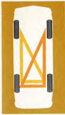
Le Volvo 145 Express est équipé d'un système de freins à deux circuits en triangle. Si l'un des circuits est perturbé, la voiture conserve 80% de sa puissance totale de freinage. Le Volvo 145 Express est en outre équipé de freins à disque servo assistés. Des limiteurs de pression empêchent le blocage des roues arrière avant celui des roues avant.
