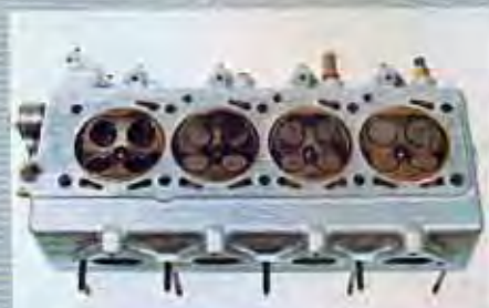
Topplöck med förbränningsrum
