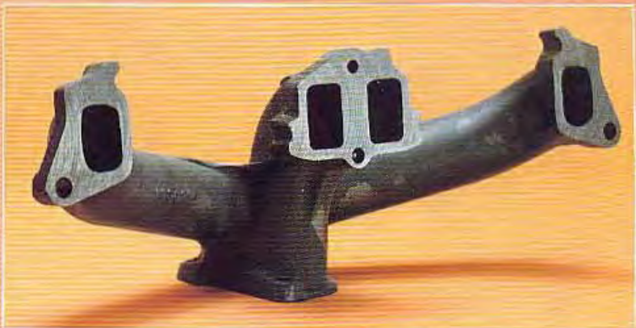
419381-9 Avgasgrenrör Avstämt extraktorgrenrör i stålplåt (140-serien). Ger en förbättring av motorns låg- och mellanvarvsmoment jämfört med standardgrenröret.
