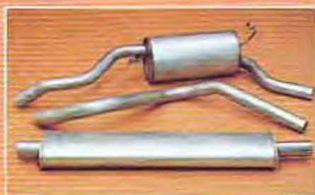
1156690-8 Rally Avgassystem Komplett för B 19-motor, fr.o.m. 1981 års modell (exkl. främre rör).
