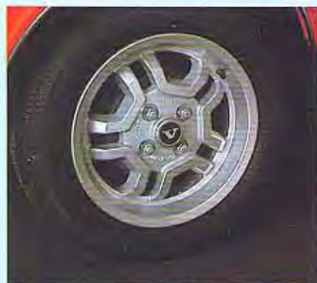
284600 Volvo 340 5 1/2" x 14" aluminiumhjul för lågprofildäck.
