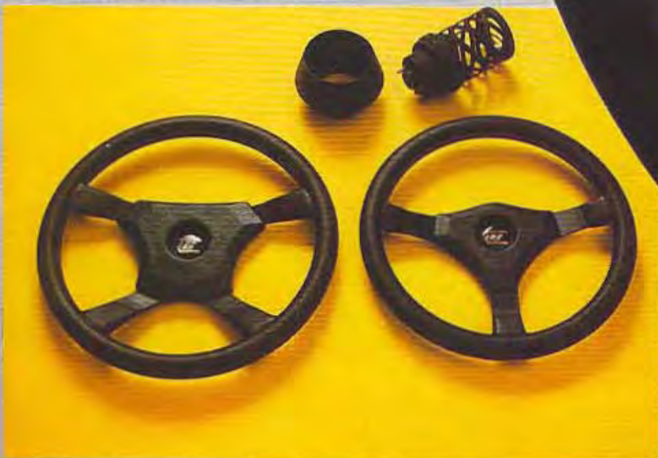
Volvos GT-rattar är försedda med s.k. kollapsnav för ökad säkerhet.
