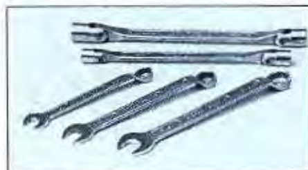
Verktyg tillverkade i högkvalitativt stål kan göras tunna och nätta utan att förlora i styrka och hållfasthet. Det gäller speciellt led- och ringnycklarnas ytterdiameter som bör vara så liten som möjligt för att underlätta mek-arbetet.
