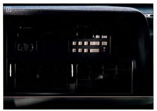
4. RADARRADION. Radarradions microprocessor kan hålla 78 olika förprogrammerade frekvenser i minnet. Radion söker sedan hela tiden efter den
