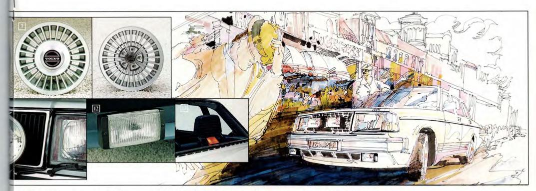
Vikt 6,8. Rekommenderad däckdimension 185/70-14. Silvergrå. Passar 240/260 fr o m 75 års modell. Stor eller liten navkapsel säljes separat. Standard hjulmuttrar användes vid stor kapsel. Kupolmuttrar säljes separat.
