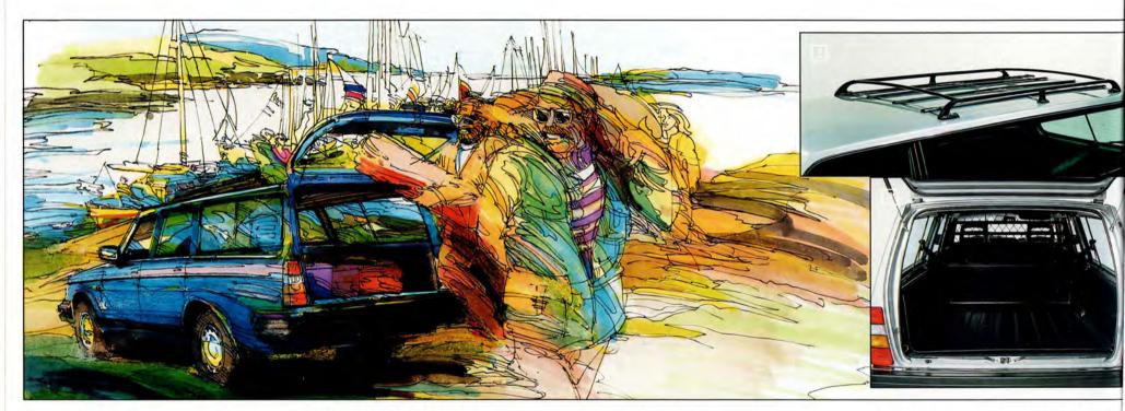
4. TAKRÄCKE I ALUMINIUM. Enbart avsett för kombimodeller. Sex fästen för stark och stabil montering. Försett med spoiler för minsta möjliga vindbrus. Maxlast 100 kg.
