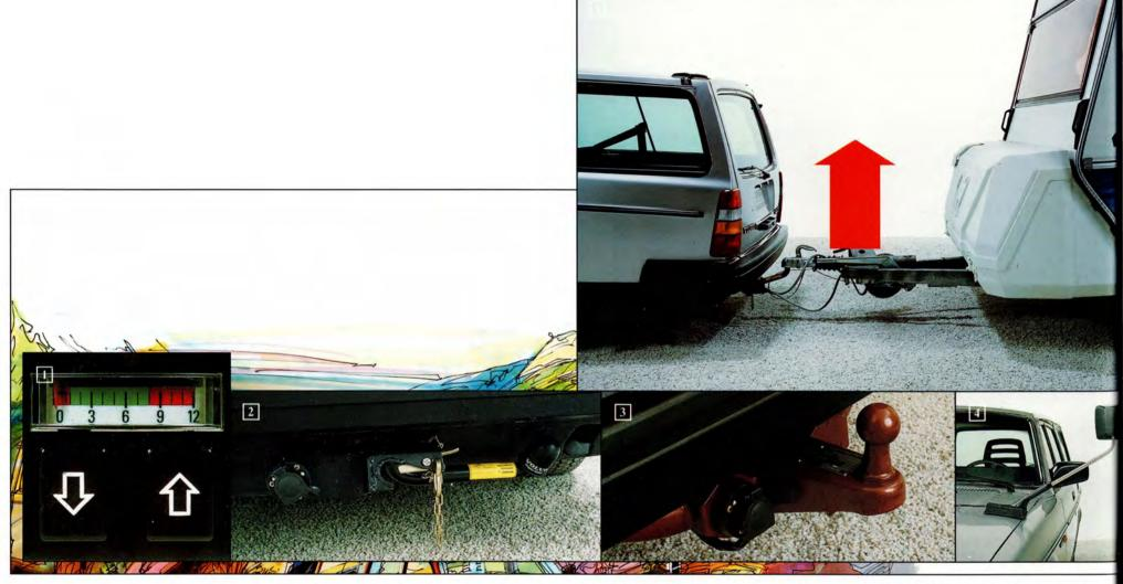
1. NIVÅREGLERING. Återger bakvagnen rätt höjd när den lastats ner av släp eller tung last. Finns i tre olika utföranden:
