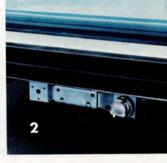
**2. Draganordning, avtagbar** Dragkroken är demonterbar. Godkänd för
