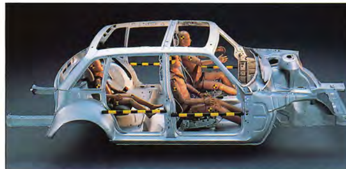
En stark säkerhetsbur, ordentliga deformationszoner fram och bak, förstärkningsrör i dörrarna och rundslagningskydd är grunden för den mycket höga krocksäkerheten i Volvo 240.
