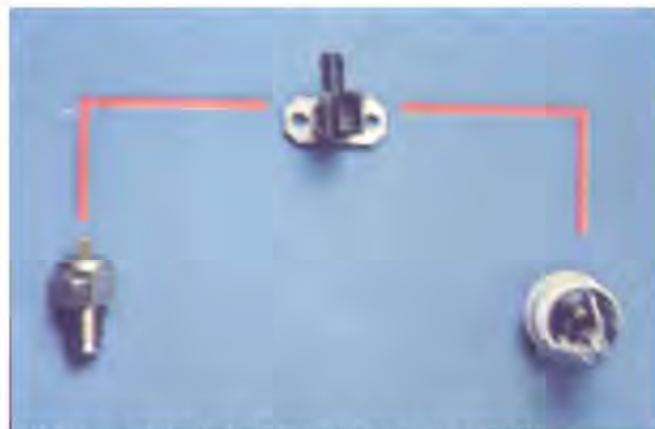
Bild 31. Elektrisk förbindning starttändlås - termo-kontakt - kallstartsventil.
