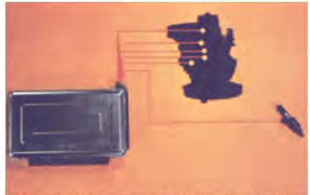
Bild 4. Styrdonet tar emot ett flertal data, som omvandlas till impulser för insprutningsventilerna.
