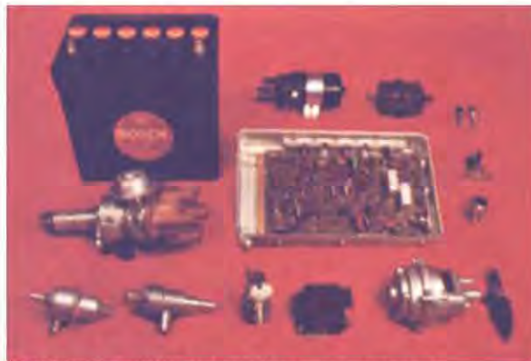
Bild 1. De viktigaste delarna i systemet.
