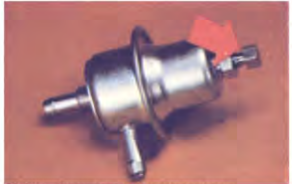
Bild 39. Justerskruv på tryckregulatorn.
