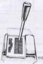
Bild 7. Växelväljare automatväxellåda 1800 E.
