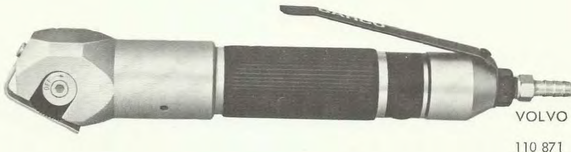
Bild 1. Plåtsåg Bacho typ PS-12
