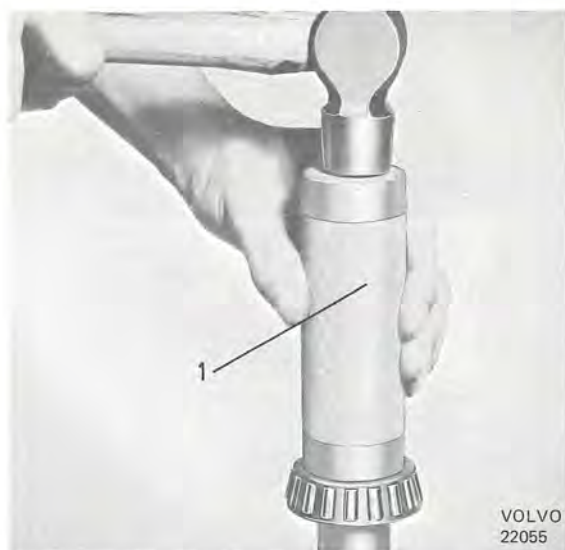
Bild 16. Montering av drivaxellager
