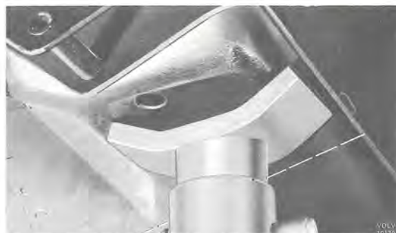
Bild 33. Placering av uppallningsbock, 140, 164
