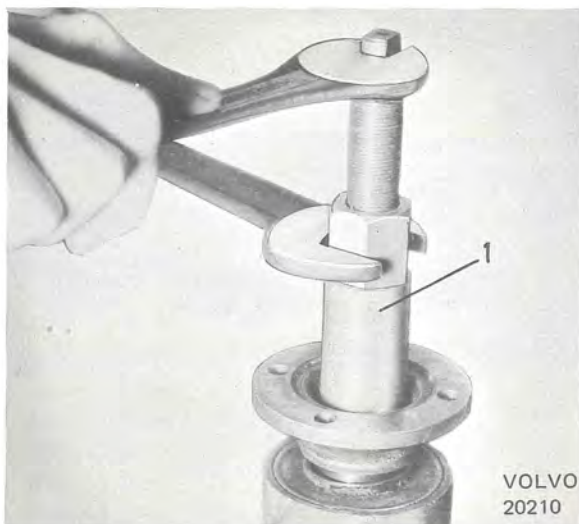
Bild 10. Montering av medbringare 1. Pressverktyg SVO 1845
