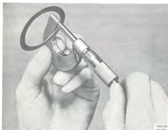
Bild 51. Uppmätning av justermellanlägg
