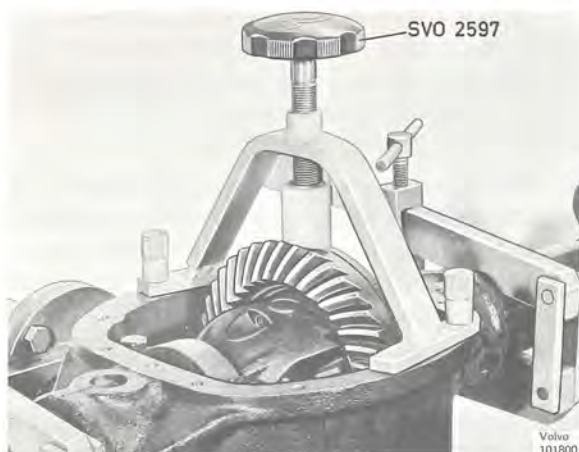
Bild 56. Bromsverktyg för differential
