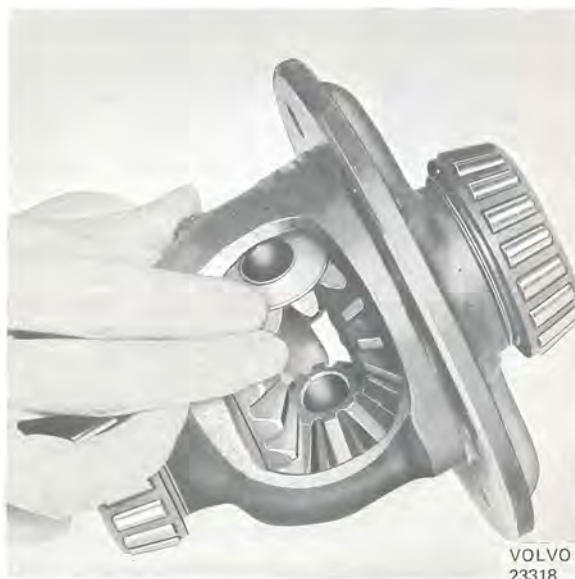
Bild 43. Montering av differentialhjul
