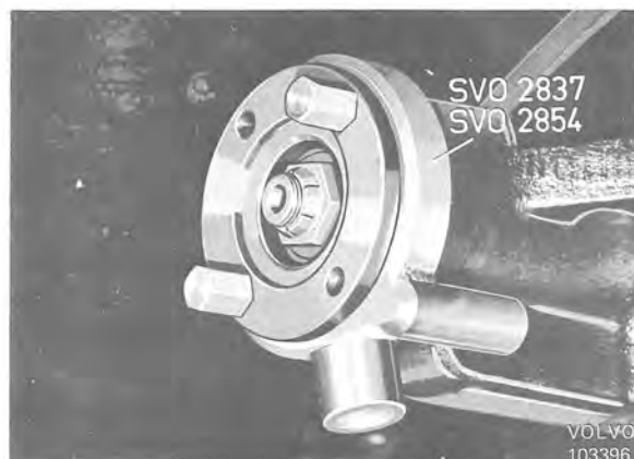
Bild 5. Mothåll för medbringare
