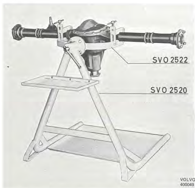
Bild 2. Stativ och fixtur för bakaxel
