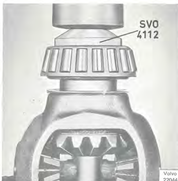
Bild 60. Montering av differentialhuslager
