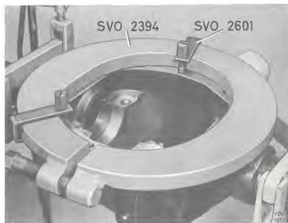
Bild 35. Utspänning av bakväxelhus
