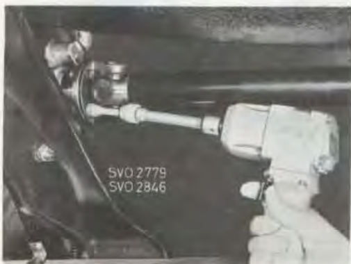
Bild 9. Demontering av skruvar till medbringare
