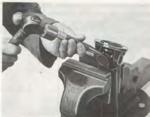
Bild 10. Utdrivning av lagerhållare, I
