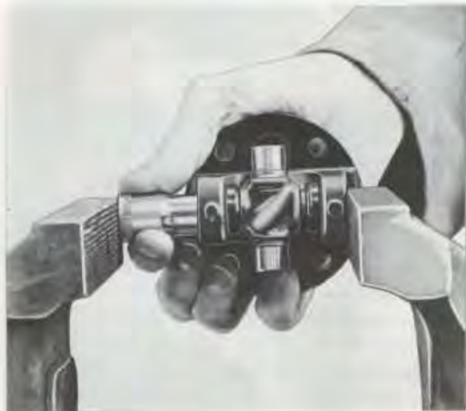
Bild 15. Inpressning av lagerhållare med hjälp av hylsa
