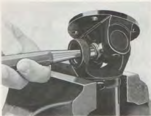
Bild 12. Utdrivning av lagerhållare II
