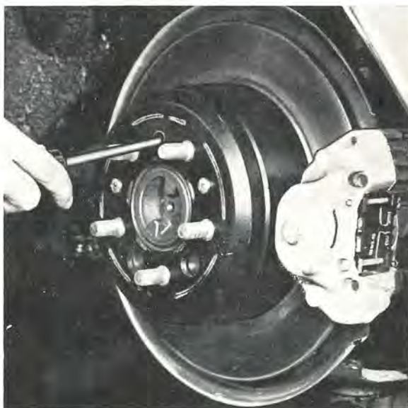
Bild 99. Justering av parkeringsbroms, bakhjul
