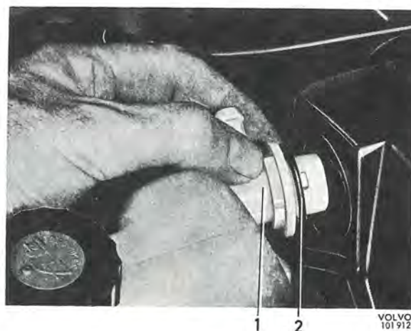
Bild 87. Montering av backventil
