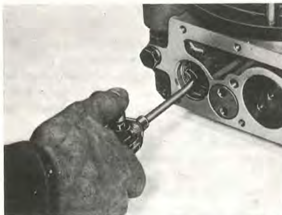
Bild 20. Renblåsning av strypmunstycke
