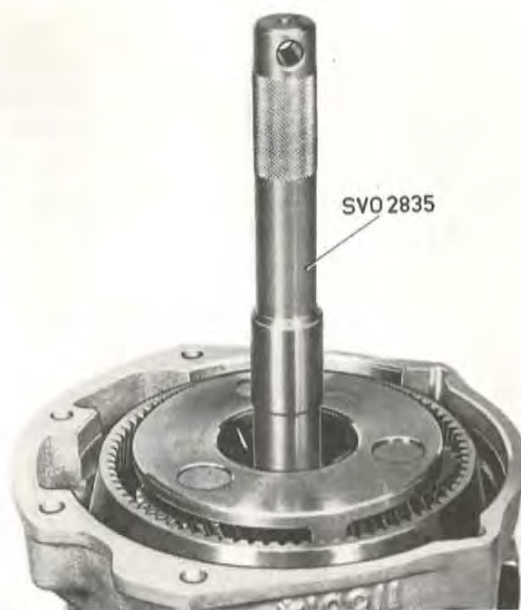
Bild 32. Montering av planethjul, II
