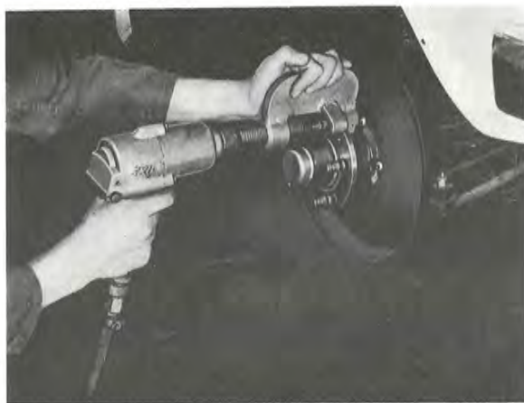
Bild 21. Demontering av hjulbult
