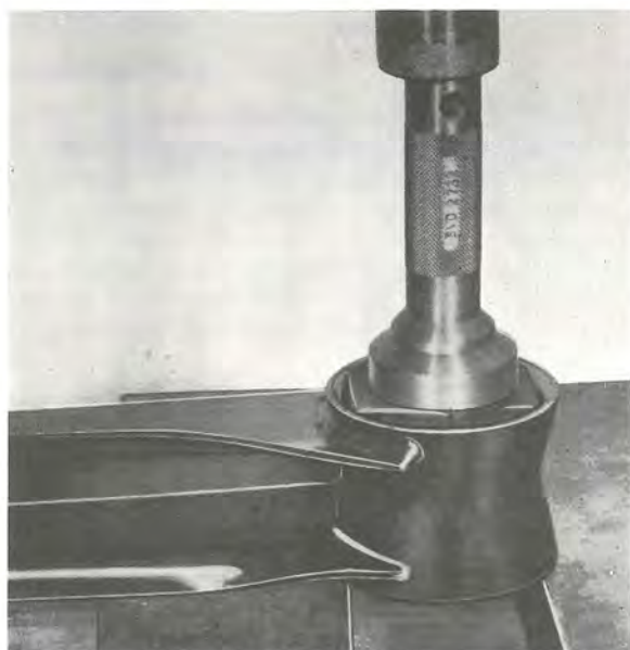
Bild 13. Demontering och (montering) av främre bussning, bärarm
