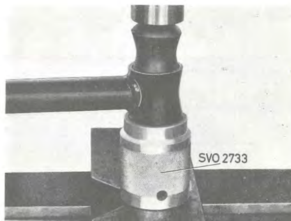
Bild 20. Montering av bussning i tvärstag (sen. utf.)
