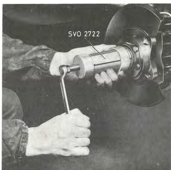
Bild 25. Demontering av inre lager
