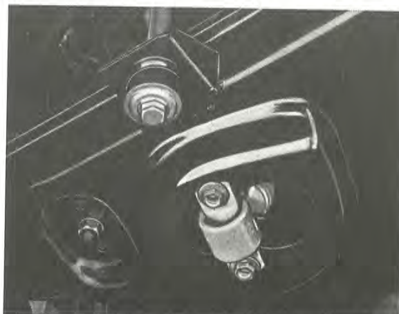
Bild 8. Nedre fäste, främre stötdämpare
