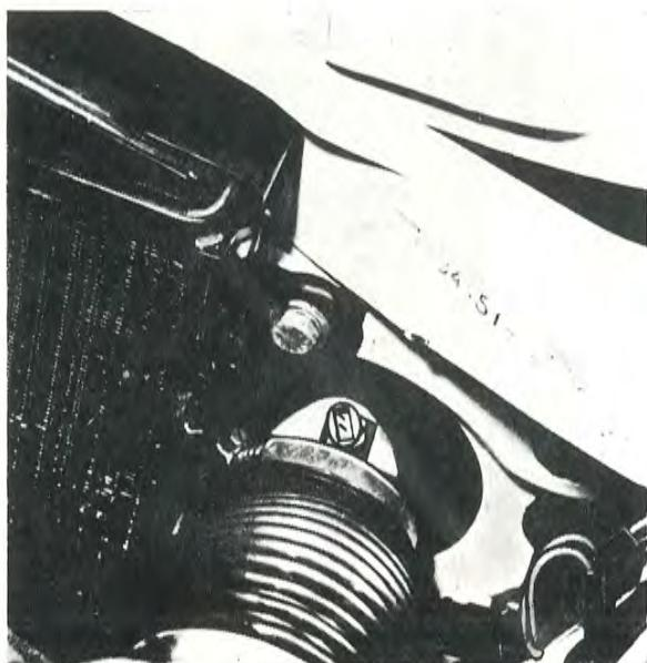
Bild 2—35. Temperaturgivare för insugningsluft
