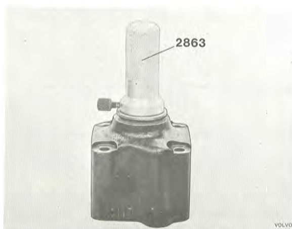
Bild 98. Montering av tätningsring
