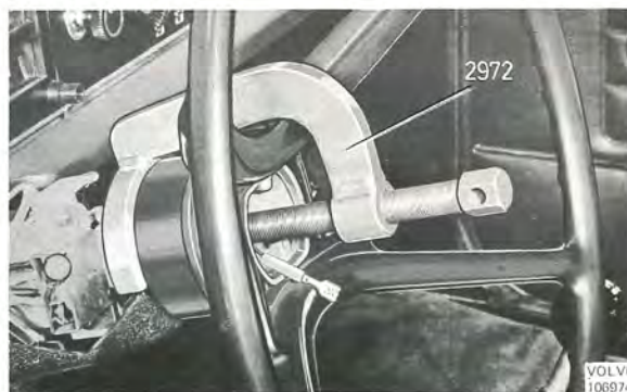
Bild 53. Demontering av ratt
