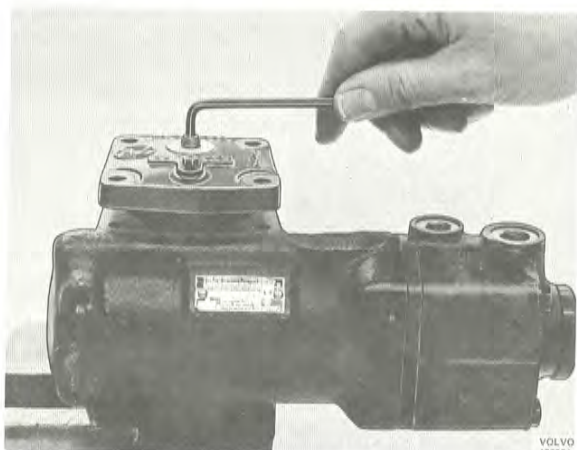
Bild 83. Demontering av lock
