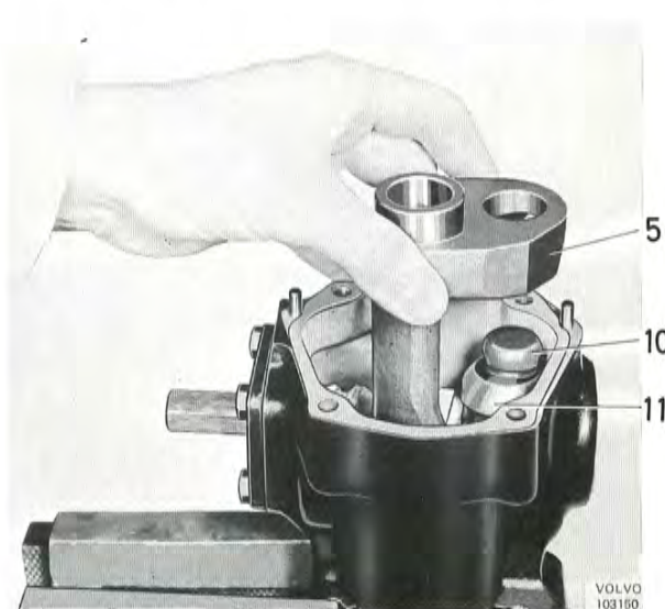
Bild 59. Demontering av styraxel
