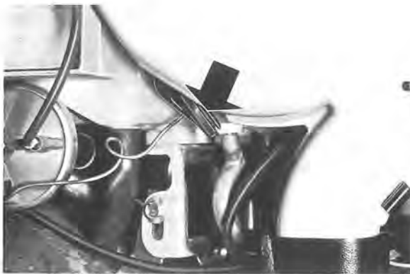
Fig. 8-65. Removing rubber grommet
