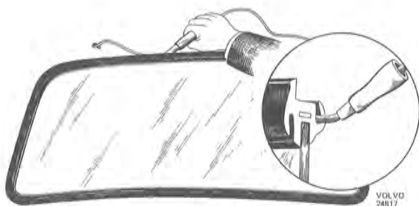
Bild 40. Insättning av snöre i gummilist
