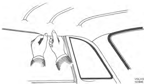
Bild 49. Demontering av takklädsel
