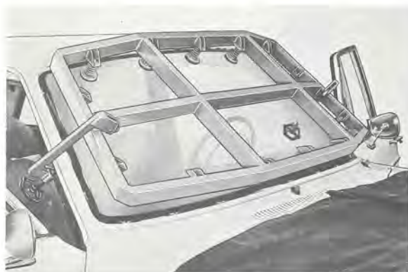
Bild 45. Montering av limmad vindruta med hjälp av fixtur 2899
