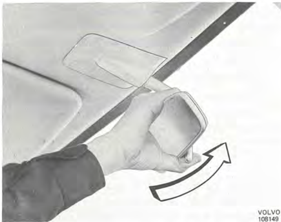
Bild 52. Demontering av invändig backspegel, 164 (senare utförande)
