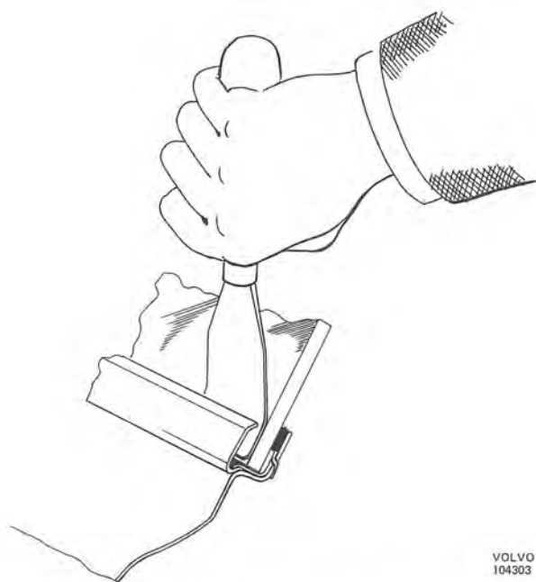
Bild 38. Demontering av vindrutans prydnadslist, (senare utförande)
