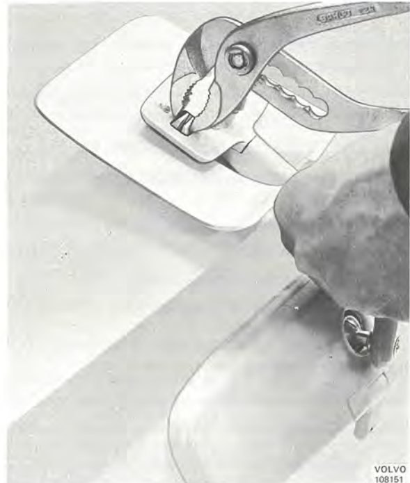
Bild 53. Lossning av prydnadskåpa från backspegel
