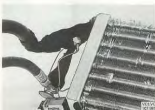
Bild 38. Isolering av ventil och utlopps rör sen.utf.
