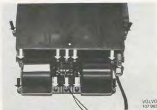
Bild 34. Demontering av överdel för aggregat
