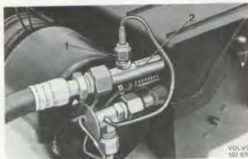
Bild 29. Demontering av expansionsventil tid.utf. 1. Förskruvning för tryckutjämningsrör 2. Klamma för kapillärspole
