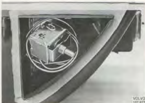
Bild 84. Placering av termostat i förångaraggregatets öppning
