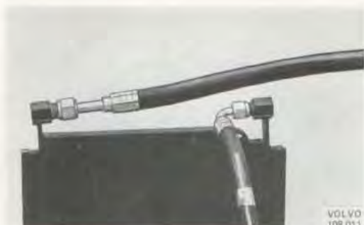
Bild 68. Montering av slangar på kondensör (140)
