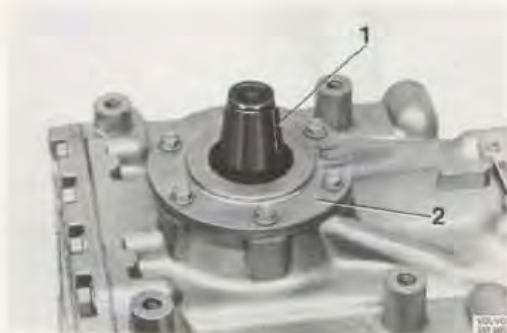
Bild 49. Demontering av gavelbricka
