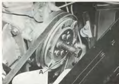
Bild 39. Demontering av kompressorremskiva A. Skruv 5/8" UNC
