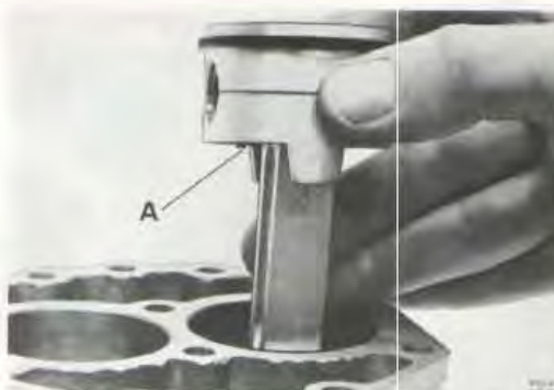
Bild 59. Montering av kolv med vevstake
