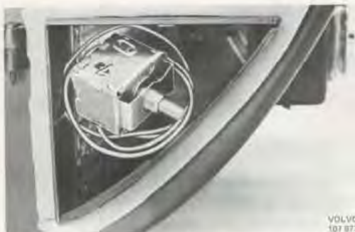
Bild 75. Placering av termostat i förångaraggregatets öppning
