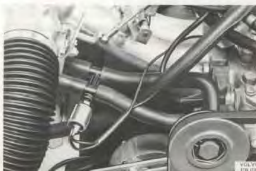
Bild 82. Magnetventil monterad på B 20 E motor
