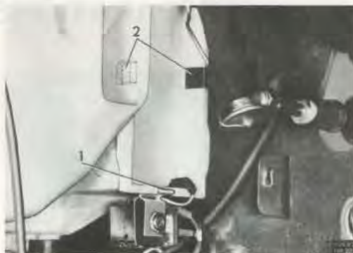
Bild 32. Demontering av förångarlock
