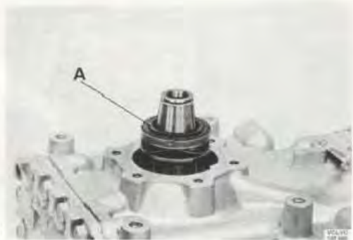
Bild 52. Montering av tätning
