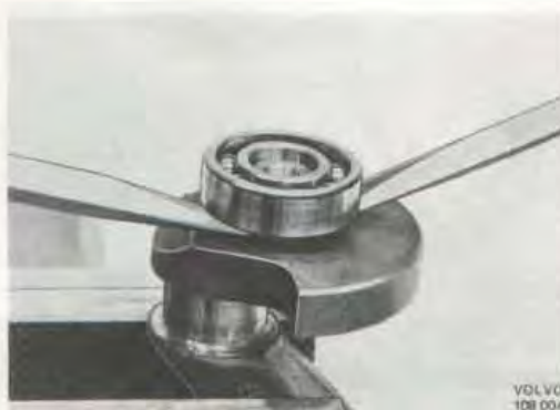
Bild 61. Demontering av bakre vevaxellager
