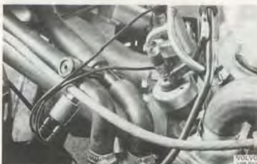
Bild 83. Magnetventil monterad på B 30 E motor
