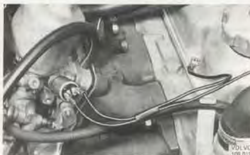
Bild 81. Magnetventil monterad i SU-förgasare
