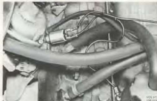
Bild 80. Magnetventil monterad i Stromberg förgasare
