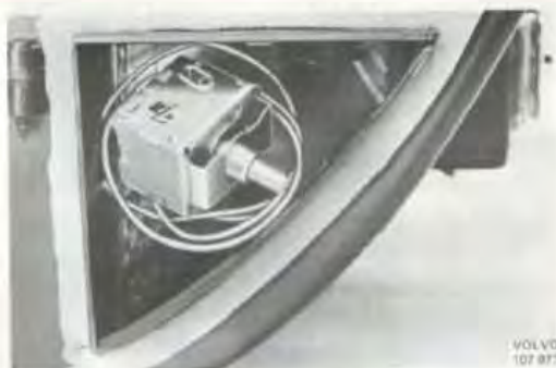
Bild 27. Placering av termostat i förångaraggregatets öppning
