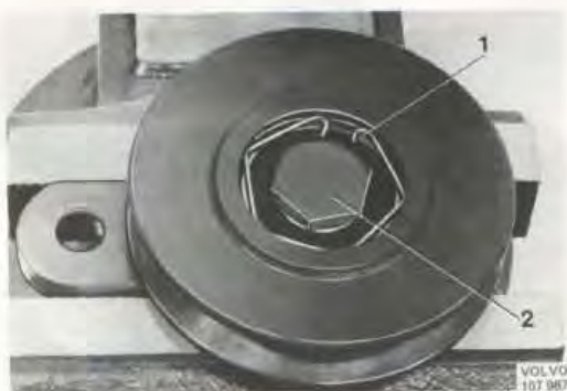
Bild 42. Isärtagning av spännrulle tid.utf.
