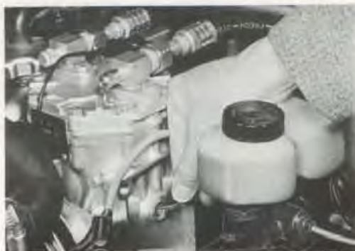
Bild 47. Kontroll av oljenivå i kompressor
