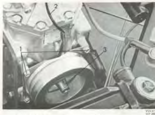
Bild 40. Demontering av elektromagnet
