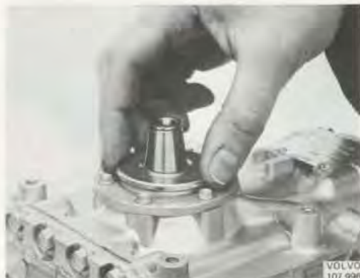
Bild 53. Montering dammskyddsbricka (endast kompressor A 209)
