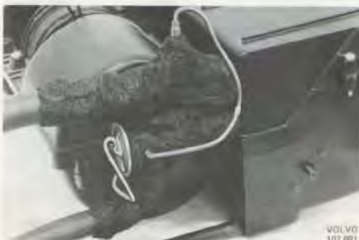
Bild 31. Isolering av ventil och utloppsrör tid.utf.
