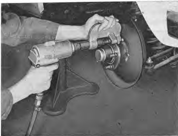
Fig. 7-16. Removing wheel stud
