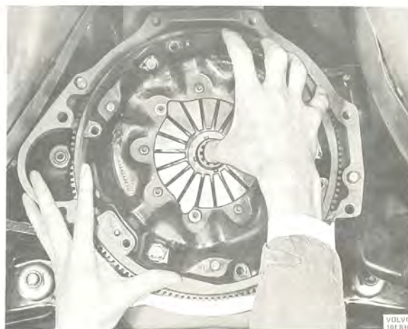
Bild 6. Demontering av koppling
