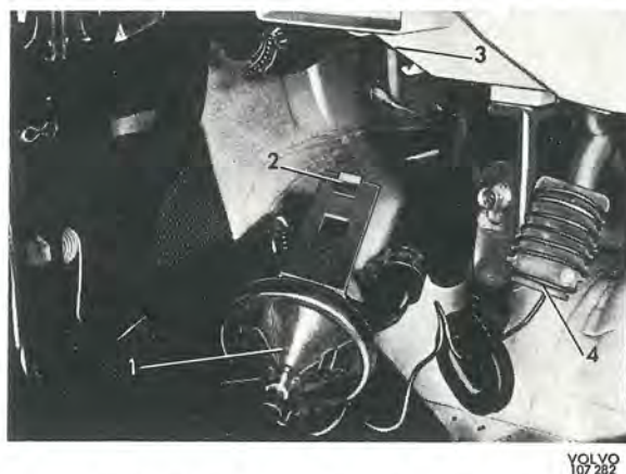
Bild 44. Byte av värmekontrollventil
