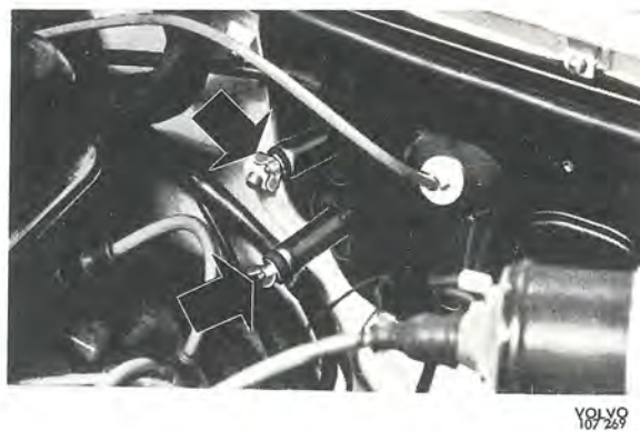
Bild 29. Pluggning av rör
