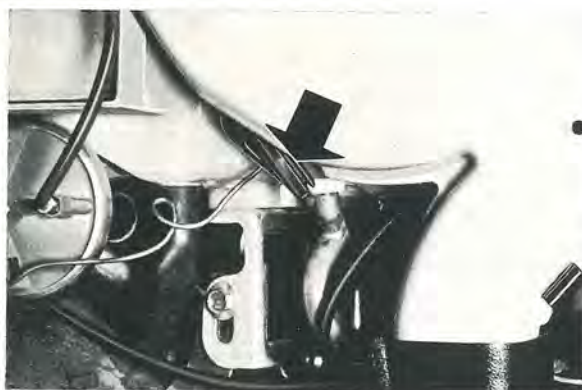
Bild 43. Demontering av gummigenomföring
