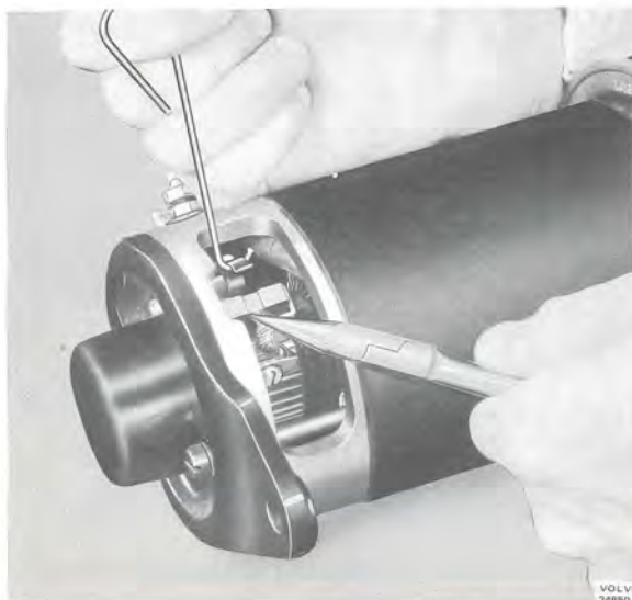
Bild 3-5. Demontering av elborste
