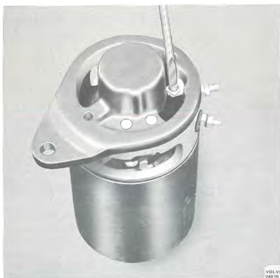
Bild 3-6. Demontering av förbindningsskena
