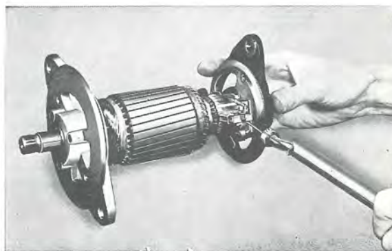
Bild 3-12. Mätning av borsttryck
