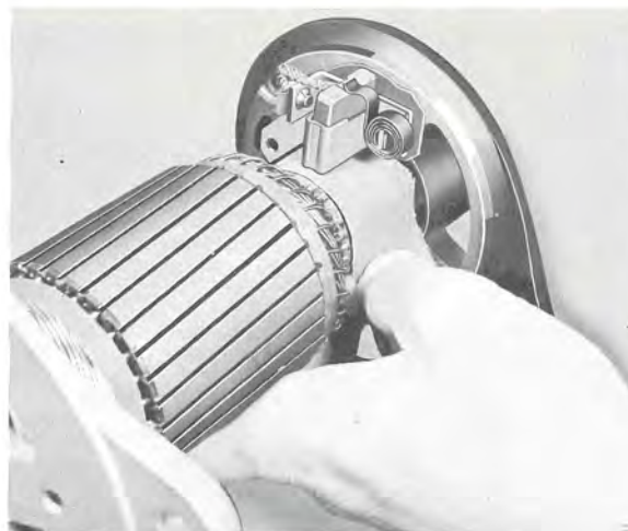
Bild 3-11. Inslipning av elborstar
