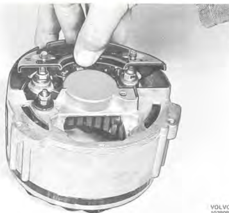
Bild 3-63. Demontering av plusdiodplatta
