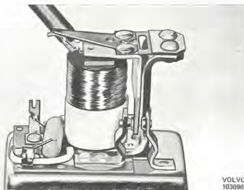
Bild 3-80. Justering av reglerspänning
