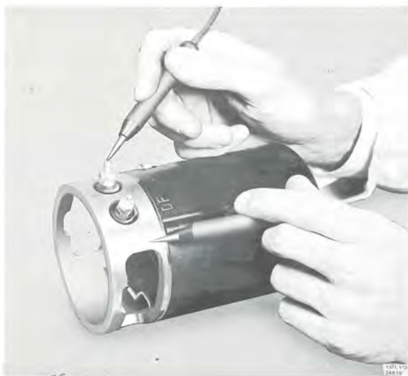
Bild 3-10. Provning av polhus
