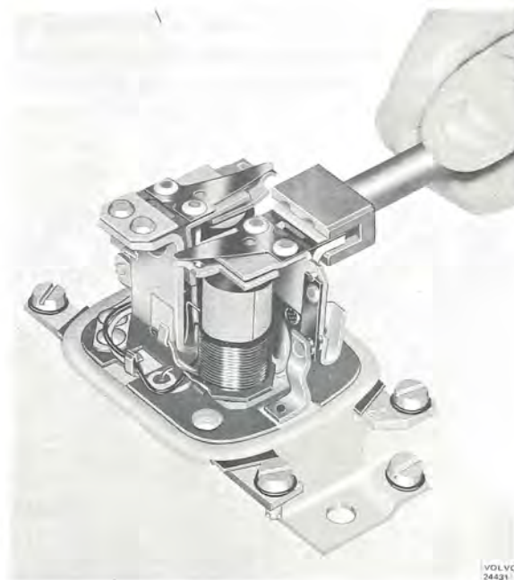
Bild 3—20a. Grovjustering av spänningsregulator
