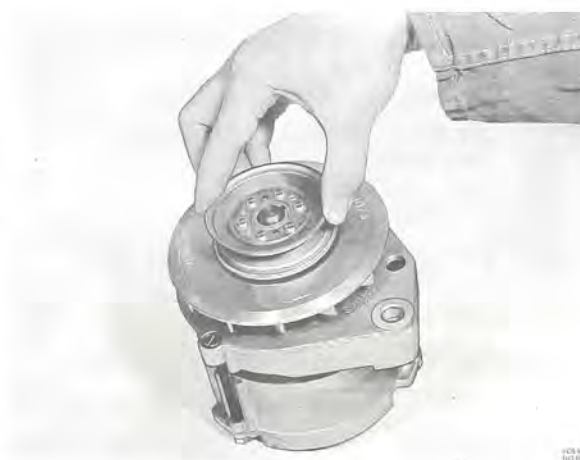
Bild 3—58. Demontering av remskiva
