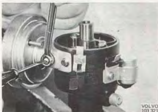
Bild 3-46. Excenter för justering av max tändsänkning
