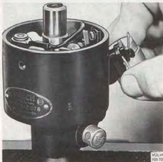
Bild 3-30. Demontering av primäranslutning, B 20 B
