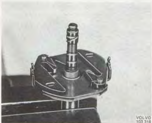
Bild 3-42. Fördelaraxel med centrifugalvikter
