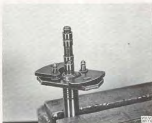
Bild 3-33. Fördelaraxel med centrifugalregulatorvikter
