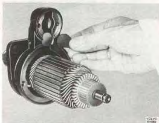
Bild 3-11. Demontering av tätningbricka
