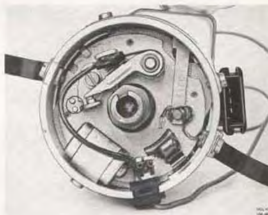
Bild 3-55. Urtag för justering av brytarkontakter
