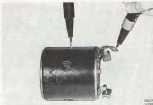
Bild 3-16. Kontroll av stator
