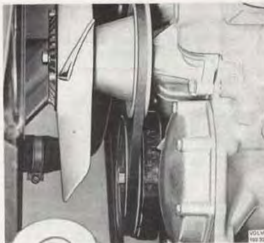
Bild 3-47. Svängningsdämpare med gradering för tändinställning
