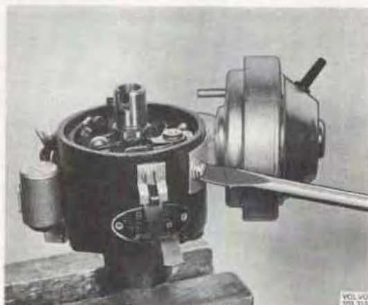
Bild 3-38. Demontering av vakuumregulator
