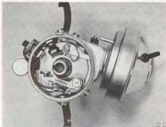
Bild 3-44. Urtag för justering av brytarkontakter
