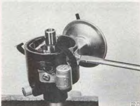
Bild 3-29. Demontering av vakuumregulator, B 20 B
