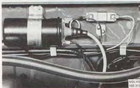
Bild 3-21. Tändspole och förkopplingsmotstånd
