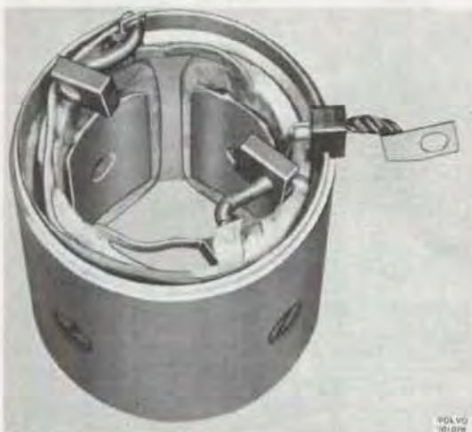
Bild 3-18. Stator med fastlödda elborstar
