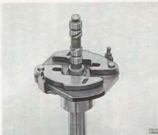
Bild 3-53. Fördelaraxel med centrifugalvikter
