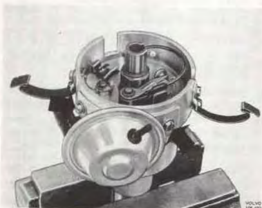
Bild 3-49. Demontering av vakuumregulator
