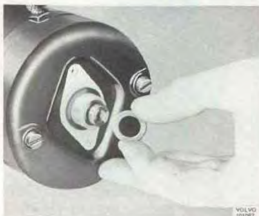
Bild 3-7. Demontering av justerbrickor
