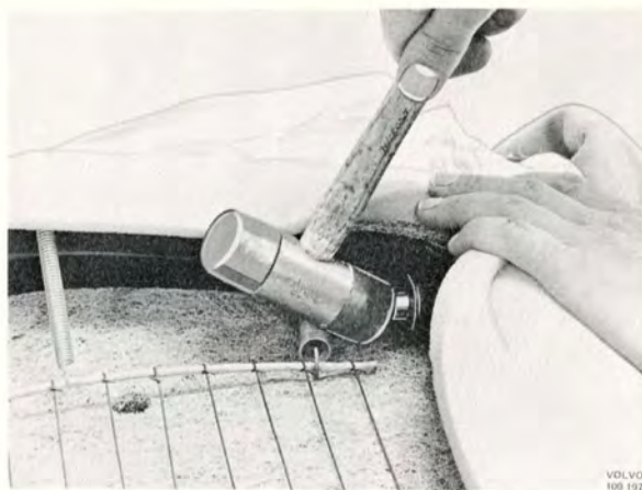
Bild 8-27. Demontering av nackskydd
