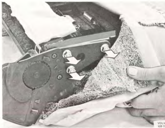
Bild 8-23. Demontering av fällbeslag
