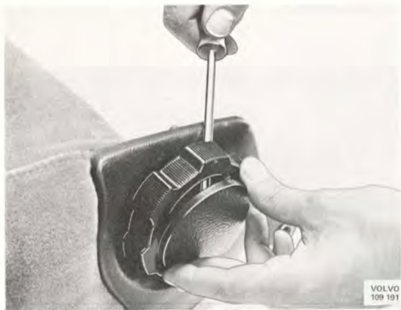
Bild 8-20. Demontering av täckbricka
