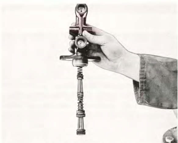
Bild 5-8. Montering av kolvsats
