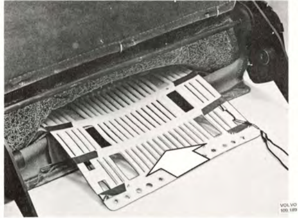
Bild 8-32. Montering av ryggelement
