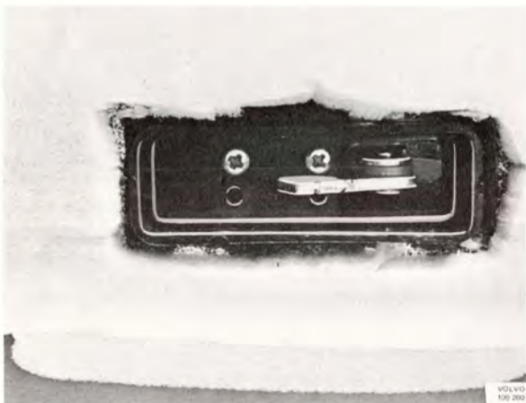
Bild 8-30. Montering av reglage och kåpa
