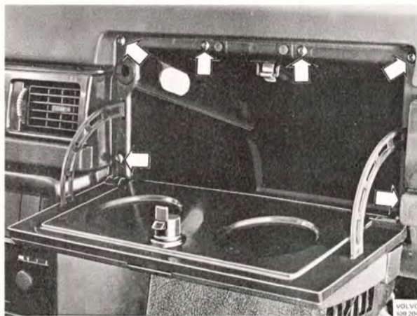
Bild 8-36. Demontering av handskfack
