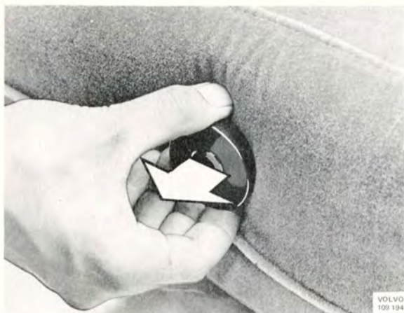
Bild 8-24. Demontering av bussning i ryggstöd
