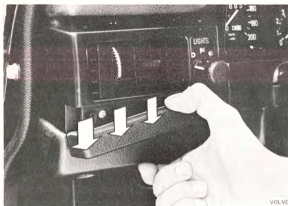
Bild 8-38. Demontering av stötlist
