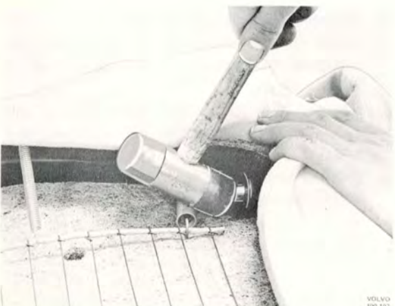
Bild 8-45. Demontering av nackskydd
