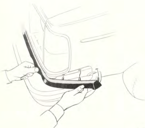
Bild 8-57. Demontering av främre täcklist
