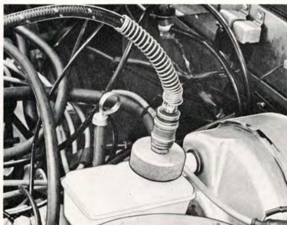
Bild 5-11. Inkoppling av luftningsaggregat
