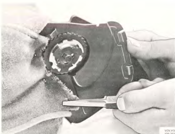
Bild 8-49. Montering av sidoklädsel
