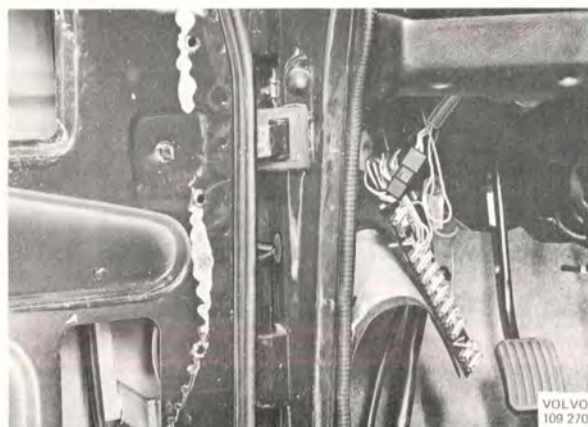
Bild 8-14. Demontering av säkringsdosa och kontaktstycken
