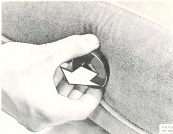
Bild 8-43. Demontering av bussning i ryggstöd
