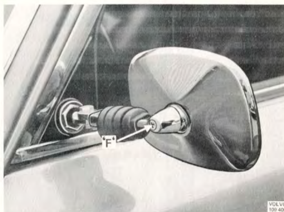
Bild 8–19. Inställning av tröghet i spegelarm "F" = 40–45 Nm (4,0–4,5 kpm)
