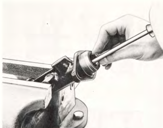
Bild 5-9. Montering av låsring
