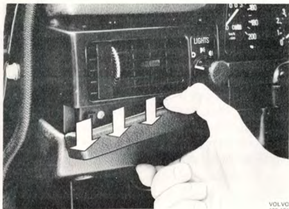
Bild 8-53. Demontering av stötlist
