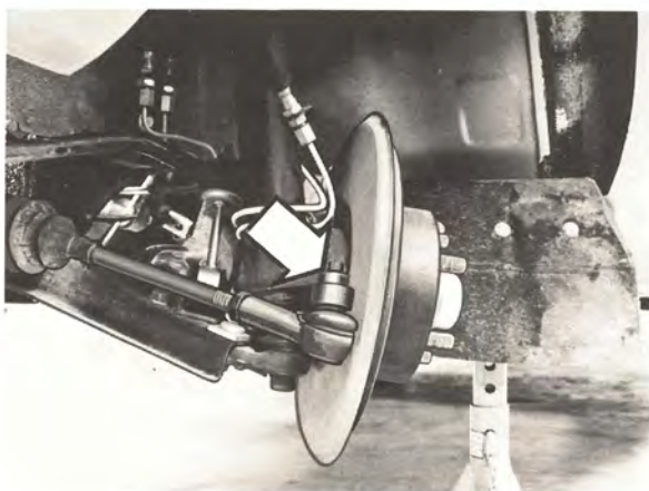
Montera styrstaget till styrarmen
