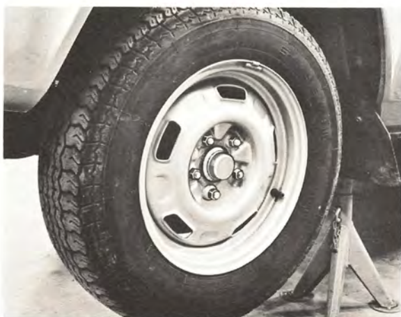
Montera framhjulen och palla ner vagnen
