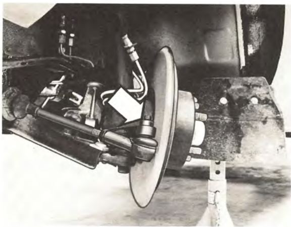
Montera styrstagen till styrarmarna
