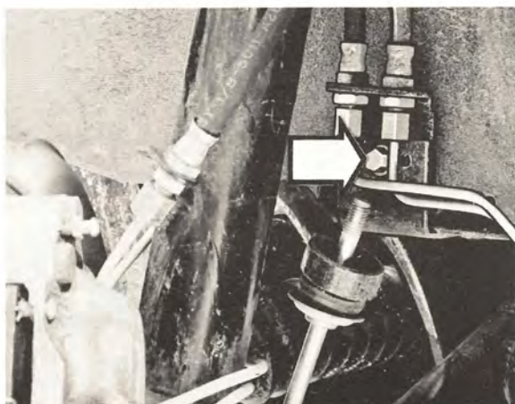
Skruva fast bromsrörskonsolen
