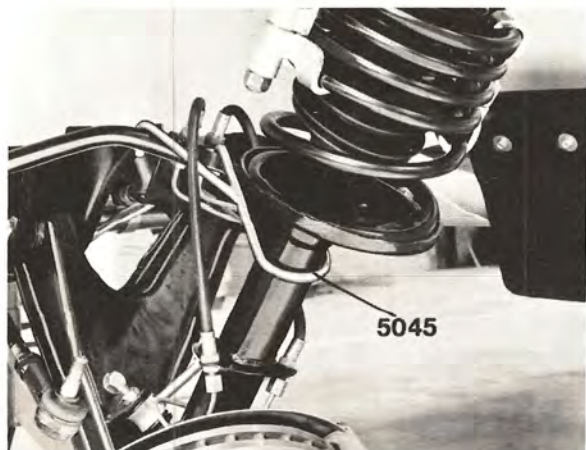
Sänk domkraften och haka i upphängningskroken
