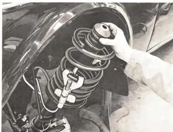
Demontera gummibufferten och stötdämparskyddet
