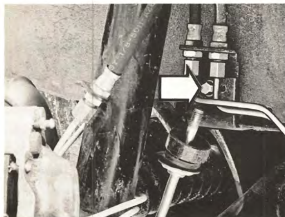
Demontera skruven för bromsrörskonsolen
