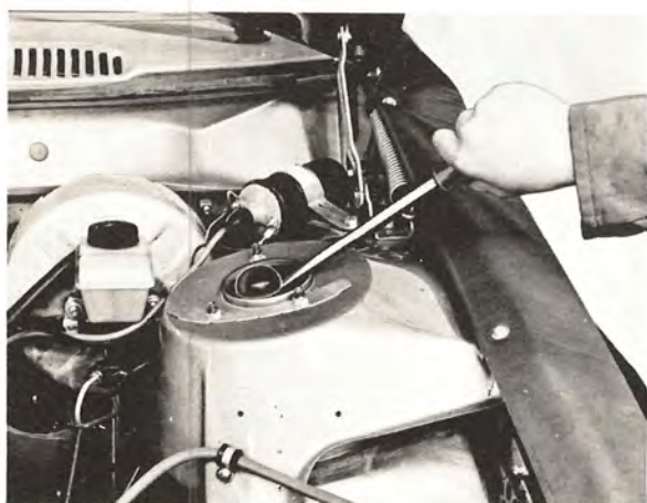
Demontera kåpan för fjäderbenets övre lagring
