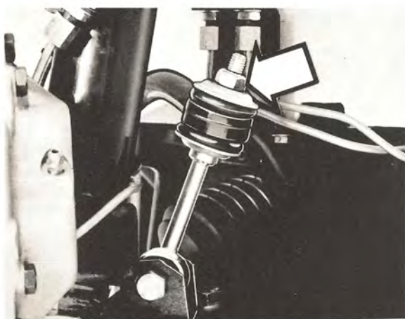
Montera länken till krängningshämman
