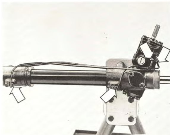
Skruva loss oljerören
