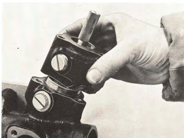
Ta bort fjädern och lyft av ventilhuset
