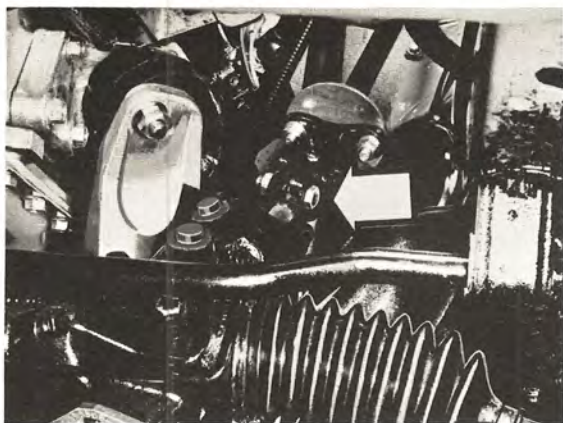
Montera låsskruven för medbringaren
