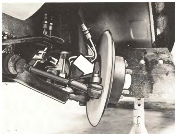
Montera styrstaget till styrarmen
