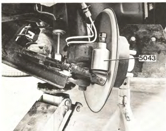
Demontera styrstaget från styrarmen . Använd 999 5043.
