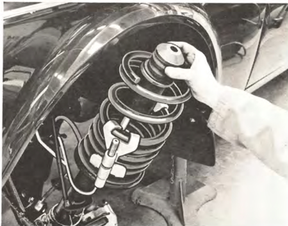
Demontera gummibufferten och stötdämparskyddet
