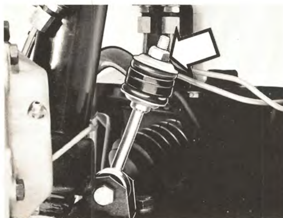
Lossa krängningshämmaren från länkens övre in- fästning
