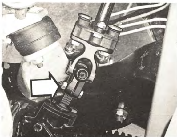
Montera l sskruven f r medbringaren
