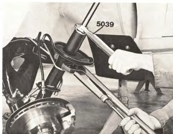
Demontera stötdämparens fästmutter
