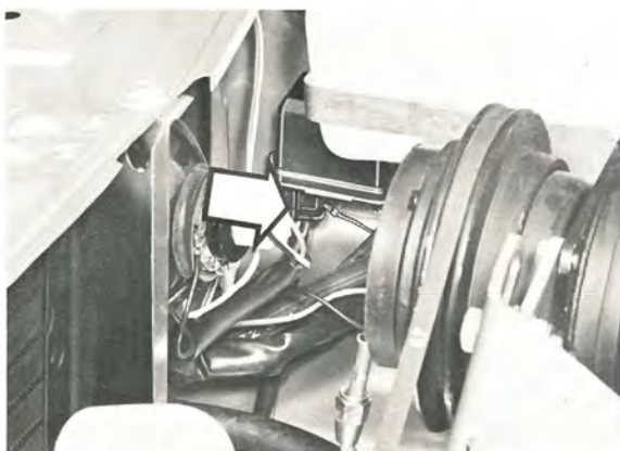
Demontera kontaktstycket från laddningsregulatorn samt klamman för ledningen
