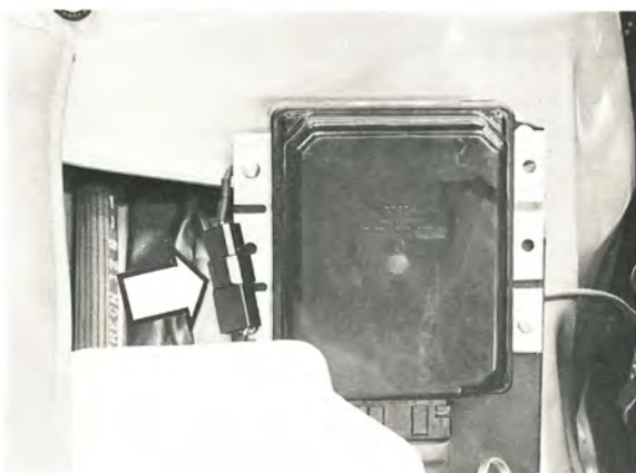
Demontera kontaktstycket för ledningen till tändför- delaren
