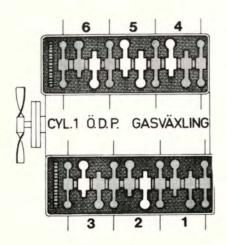
B. Dra runt motorn ett varv till ÖD. Ventilerna till 1:ans cylinderväxlar.
