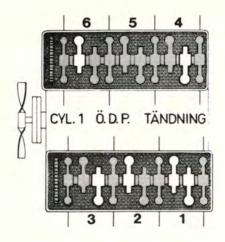
A. Vrid vevaxeln till ÖD. Tändläge för cyl. 1. Kontrollera och vid behov justera följande ventiler:
