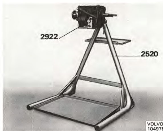
Bild 2. Stativ och fixtur, används vid isärtagning och hop-sättning av växellåda
