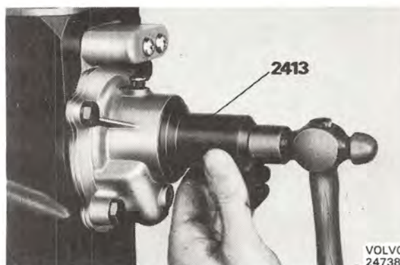
Bild 17. Montering av tätningssring
