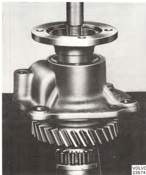
Bild 23. Isärtagning av huvudaxel, M 40
