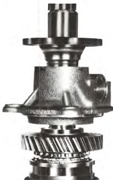
Bild 28. Montering av bakre lock och medbringare, M 40
