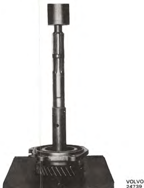
Bild 22. Isärtagning av huvudaxel, M 41
