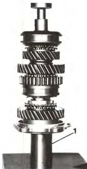
Bild 29. Montering av bakre lock, M 41
