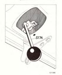
För borttagning av clipset finns ett verktyg 999 5174. Verktyget har en skåra och en magnet där clipset kan sättas fast.
