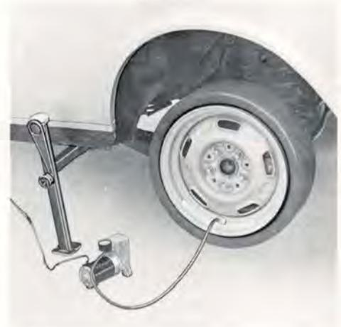
5. Pumpen Sie das Reserverad mit einem Druck von 250 kPa (=zwischen 2 u. 3 auf der Manometerskala) auf. Hängen Sie den Luftpresser ab, wenn dieser Druck erreicht ist und schrauben Sie die Schutzkappe auf das Reifenventil.
