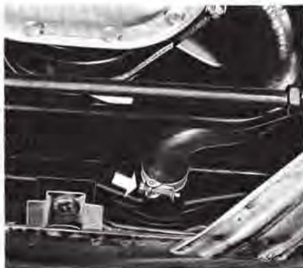
Das Auffüllen der Kühflüssigkeit geschieht durch den Kühleinfüllstutzen, wobei der Heizungsregler (TEMP) vorher auf Höchstleistung gedreht wird, damit die ganze Anlage einsch. Heizung gefüllt werden kann.
