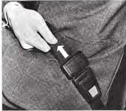
Wenn der Gurt **verkürzt** werden muß, ziehen Sie einfach am oberen Ende des Hüftgurtes. Die Sicherheitsgurte im Fond sollen stets griffbereit an Haken in den Rückfensternischen aufgehängt sein, solange sie nicht benutzt werden.
