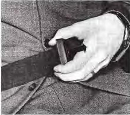
Soll der Gurt **verlängert** werden, dann zuerst das obere Ende des Hüftgurtes entspannen. Halten Sie danach den Stellspanner mit der einen Hand und ziehen Sie mit der anderen den Hüftgurt auf die gewünschte Länge aus. Strecken Sie den Gurt am oberen Ende!
