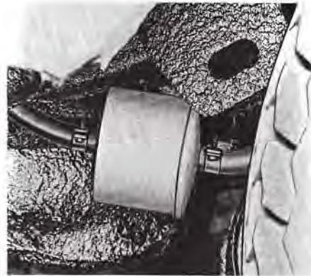
werden. In Wagen mit Einspritzmotoren (B 30 E) soll das Filter alle 20 000 km gereinigt werden; in Wagen mit Vergasermotoren (B 30 A) alle 40 000 km.
