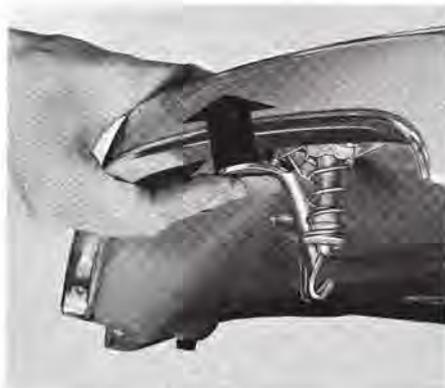
Sie wird geöffnet, indem der Haken, wie auf der Abbildung gezeigt, nach innen gedrückt wird. Kontrollieren Sie nach dem Herunterklappen, daß die Haube ordentlich gesperrt ist. Die Lage der Motorhaube kann höhenmäßig verstellt werden, indem die Gummistopfen ganz vorn auf der Unterseite der Haube und auf den Kotflügeln unterhalb der Windschutzscheibe entsprechend heraus- oder hineingeschraubt werden.
