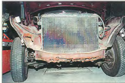
De dwarsbalk onder radiator is een zwak punt.
