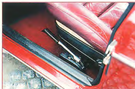
Wat heeft Volvo aangezet tot deze bizarre plaatsing van de handrem?
