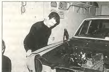
De originele voorschermen konden na het stralen zo weer gemonteerd worden.
