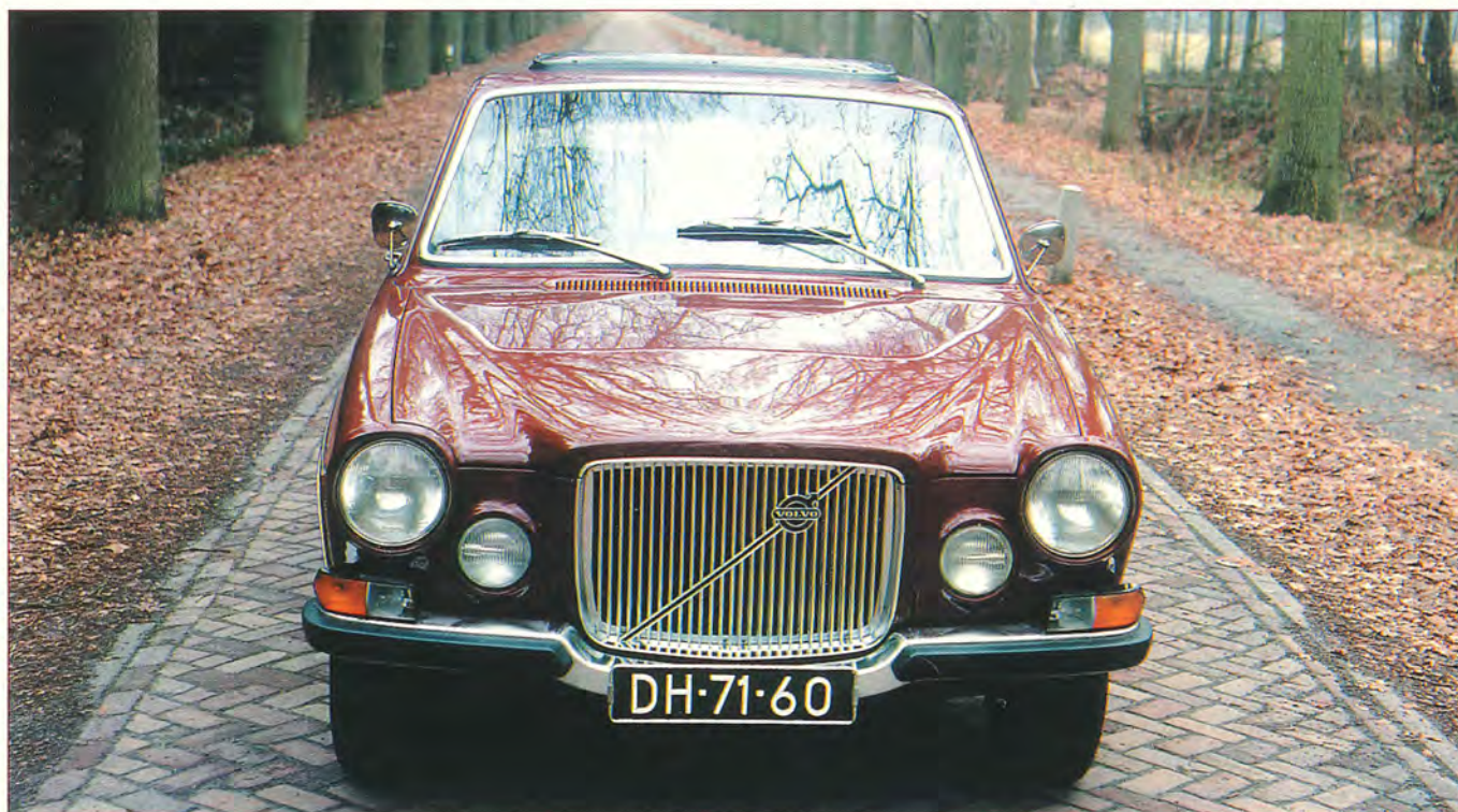
De hoge grille en de gebogen voorbumper waren een typisch kenmerk van de oer-164. Het '72'er model kreeg een rechte bumper.
