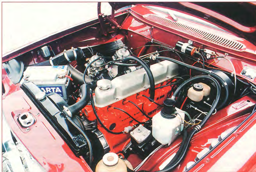
De zes cilinder (B 30) was in principe een B 20 met twee extra cilinders.
