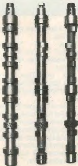
Timo slipar kamaxlarna själv för att de ska hålla måttet. T.v. ett ämne, i mitten en av Timos kammar och t.h. en massproducerad kamaxel av amerikansk typ. Observera skillnaden i grovlek.
