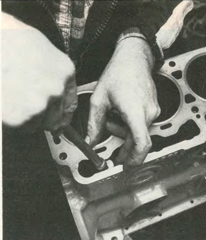
Korken lirkas på plats och trycks sedan fast. Man kan med fördel använda korken från vanliga vinflaskor. Diametern ska vara 22–23 mm.
