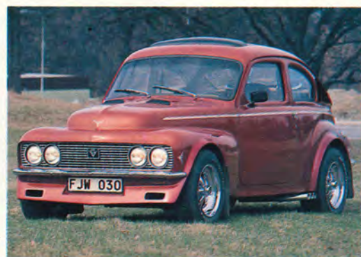
Percys fräcka PV har Bilprovningens välsignelse. Den är godkänd med både V6-motor och 8,5 tums Keystonefälgar.
