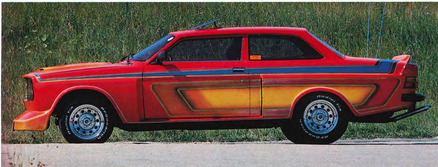
Tack vare att takstolparnas lutning ökats, har Volvon fått elegantare linjer. Taket är choppat 12 cm fram och 10 cm bak. Lacken är en färgglad kombination av acryl och candy på silverbas.
