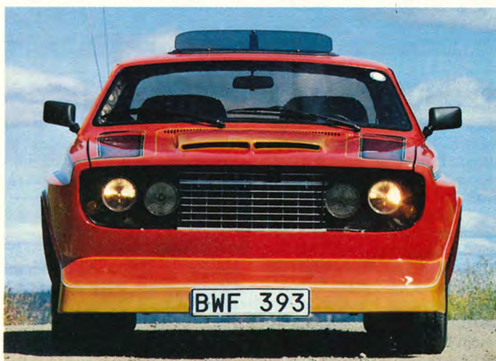
Dubbla strålkastare från VW Scirocco, upp och nedvänd Opel Diplomatgrill och nätt scoop sätter extra krydda på den CanAm-inspireerade Volvon.
