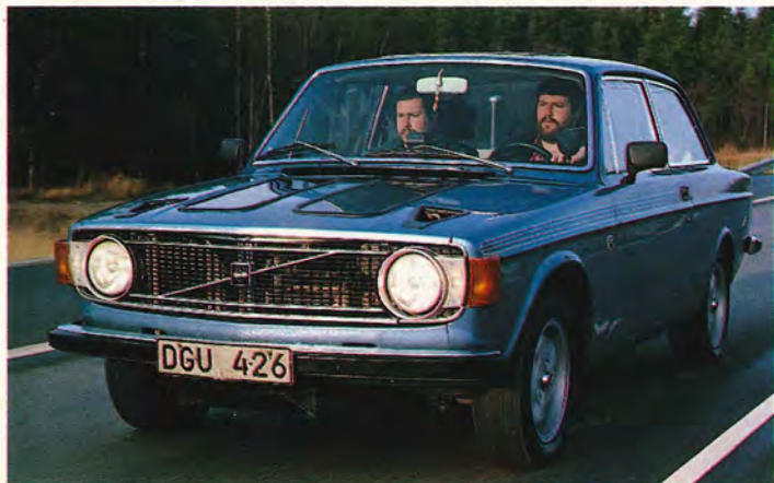
En ulv i fårakläder. Lägg märke till luftintaget under stötfångaren. Det är till för att kyla själva turboaggregatet.
