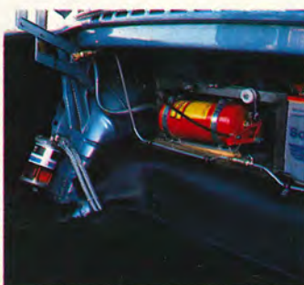
I bagaget sitter tuben till det högeffektiva sprinklersystemet.
