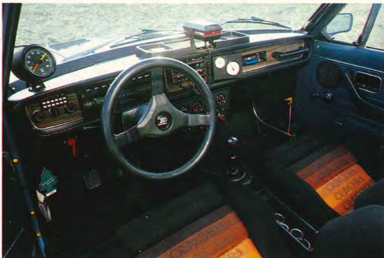
Komplett inredning med Recarostolar, sportratt, färdator, radarvarnare samt mätare för bränsletryck, laddningstryck, oljetryck, oljetemp. med mera.
