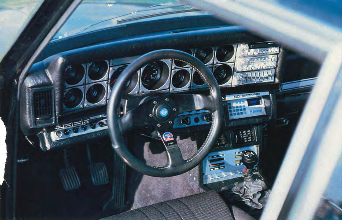
Ingen ting kvarstår av Volvons ursprungliga instrument. Eivind har istället monterat in tolv olika mätare, monterade i en panel av glasfiber.
