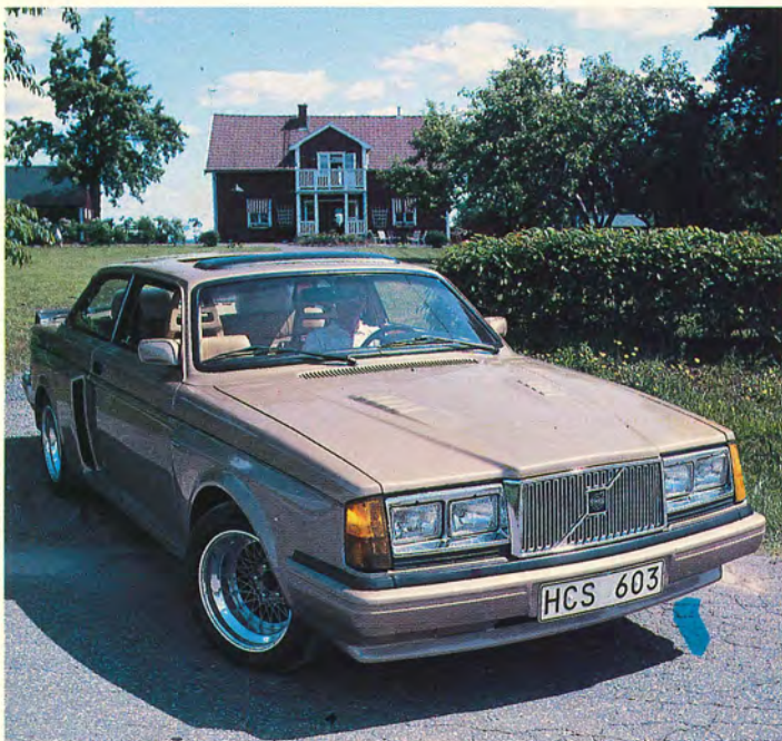
Den kompakta fronten har Leif fått genom att använda 83:ans frontplåt. Den är fyra centimeter lägre och krävde en hel del modifieringar innan allt passade.
