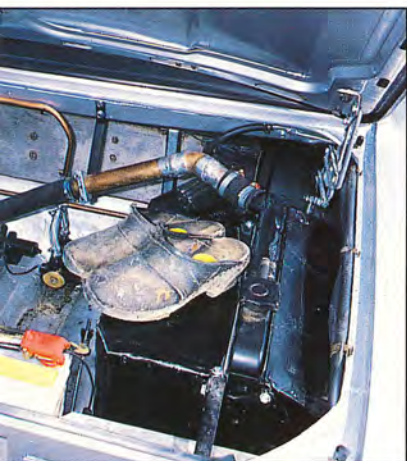
Dubbla kylare i kofferten förser motorn fram med avkyllt vatten.
