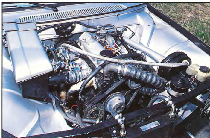
Volvo B20-motorn är numera lika vass som Volvo-karossen är slät. Borrard och strokad till 2360 cc. Scoopet har Oskarshamnar'n knackat i plåt.
