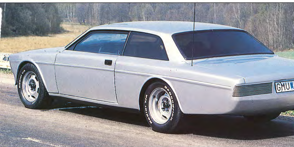
11 cm takchoppning, 9 cm sektionering och 10 cm fjädersänkning har gjort 142:an superlåg. Tillsammans med breddade originalfälgar och lågprofil racing-däck blir väghållningen superb. Notera avsaknaden av dörrlås, backspeglar...
