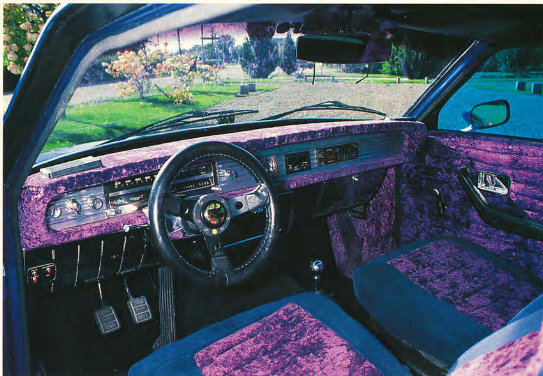
Molle inspirerades av gode vännen Björn Petersons Corvette T-top -78 (se Bilsport 22/86). Därför är instrumentbrädan utbyggd för att få ett djup till instrumenten. Själva panelen är täckt med ribbad aluminium.
