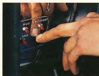
Med hjälp av en liten dator på instrumentpanelen öppnas bland annat huven och tanklocket elektriskt.
