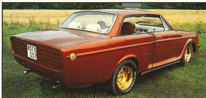
Peter Oskarsson bil är en "shorty". Hela karossen är kortad 26 centimeter. Dessutom är skärmarna utlagda, fjädring och tak sänkt.
