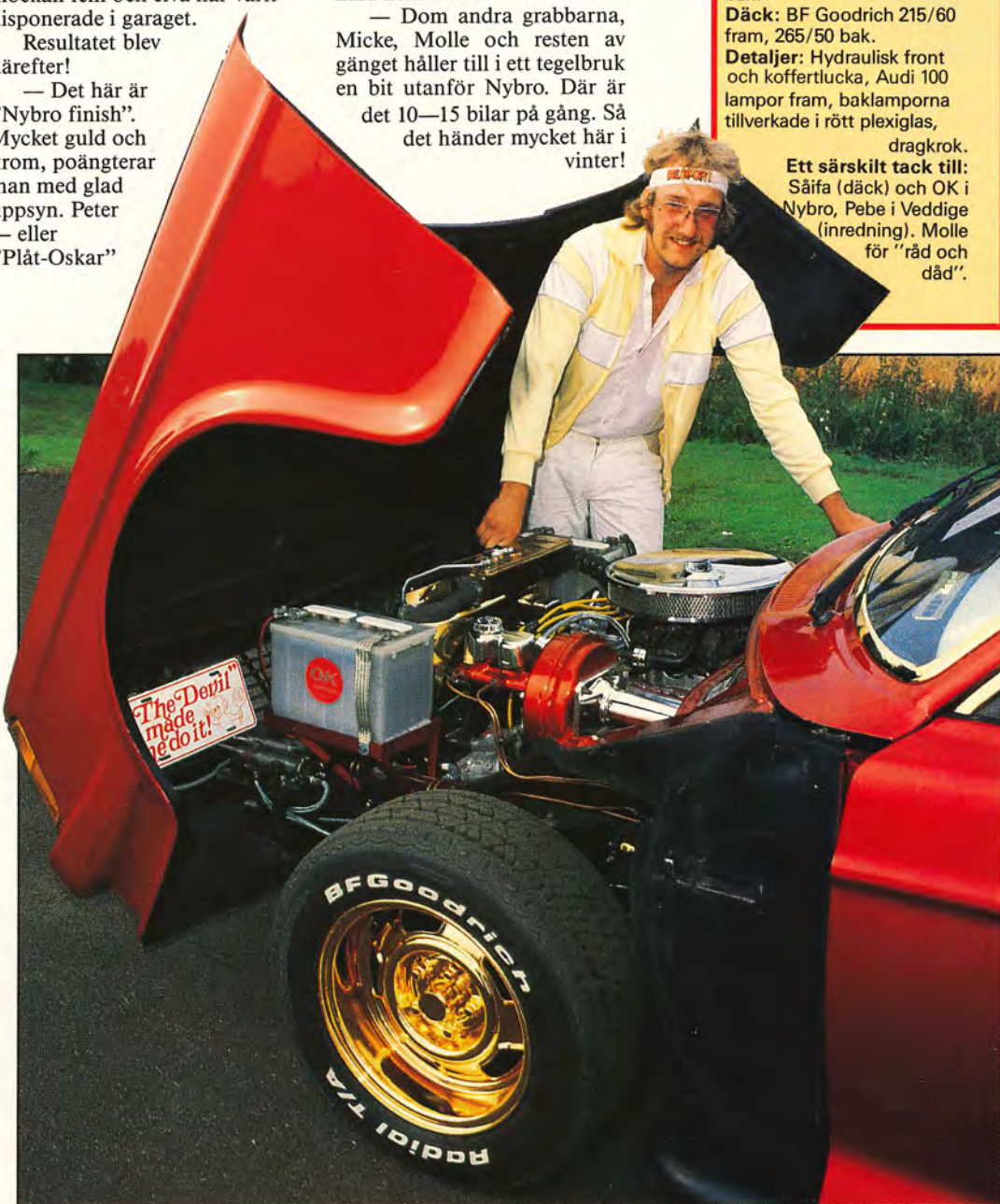
Säsongens största nyhet sitter under huven. En V8 med Volvos emblem... Förbryllande? Läs texten så får du veta sanningen om motorn. Hela huven öppnas elektriskt med hydrauler.
