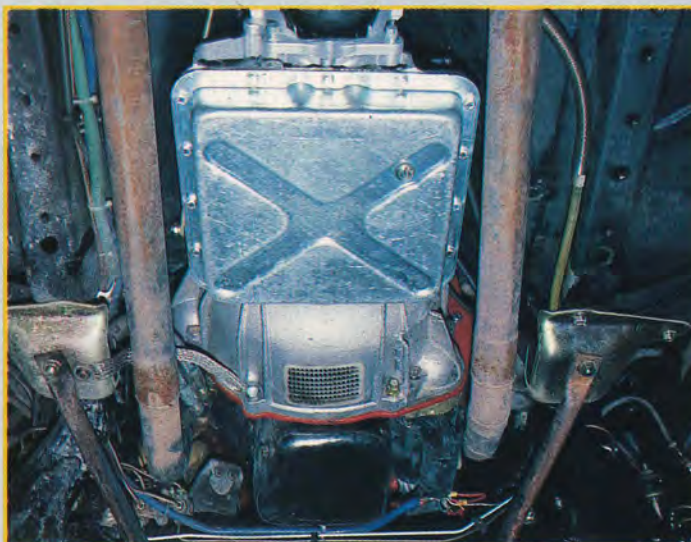
Här syns dom två undre panhardstagen som ingår i ambulansbryggan. Kent var tvungen att svetsa ett nytt öra och vända startmotorn upp och ner.
